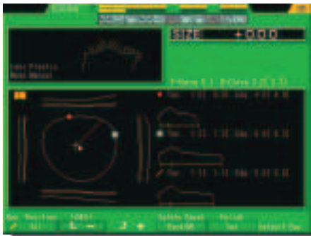
Facettenlagensimulation (grüner Hintergrund) Im manuellen Modus kann der Benutzer die Facettenlage justieren. Mit dem ALE-5000SG können sowohl die Rilllage als auch die Glasabkantung justiert werden.
